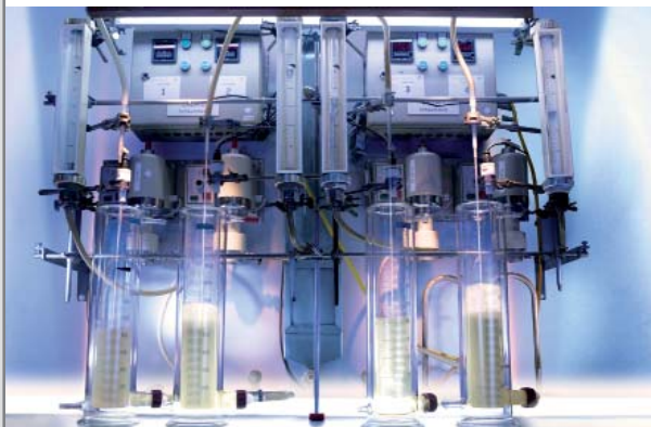
Test de espuma según norma CNOMO D65 5215
